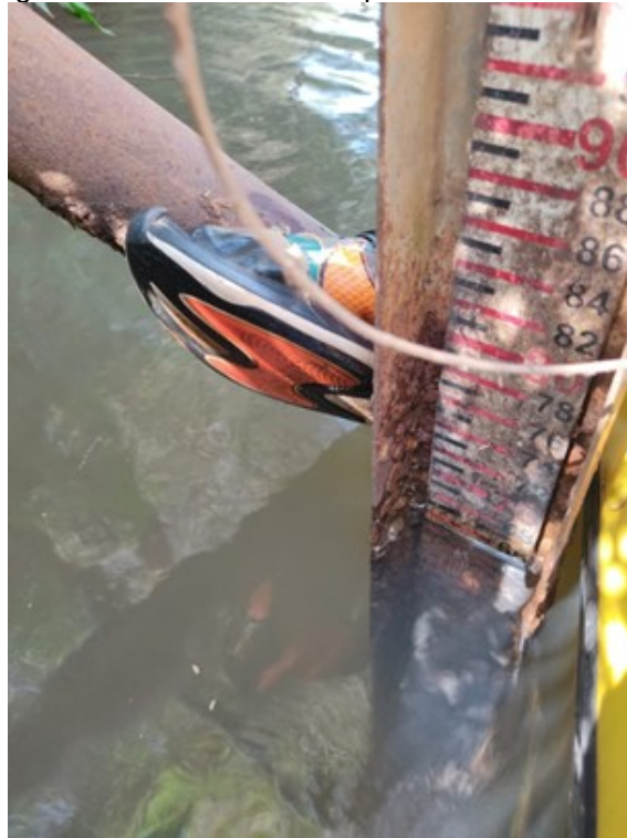
Figura 42. Régua Linimétrica instaladas pela ENVEX em diferentes vistas.
