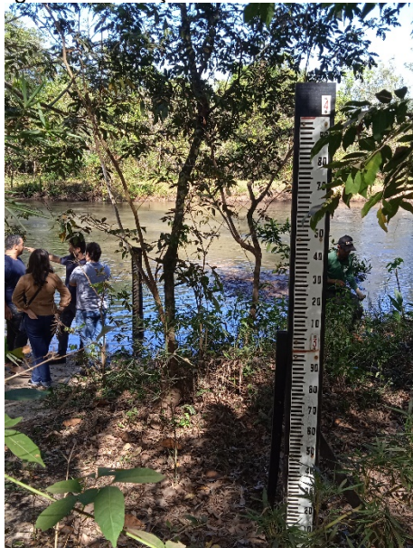
Figura 14. Estação Fluviométrica DAEE.
