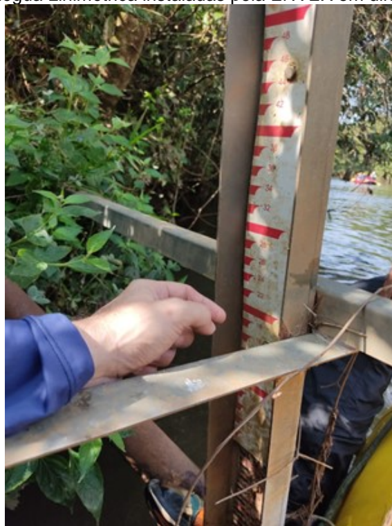
Figura 43. Régua Linimétrica instaladas pela ENVEX em diferentes vistas
