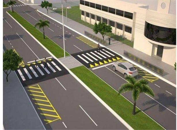
Figura 216 - Sinalização horizontal e vertical para travessia elevada de pedestres.
