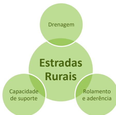
Figura 123 - Esquema de aspectos que impactam a qualidade de estradas rurais. Fonte: Polo Planejamento
