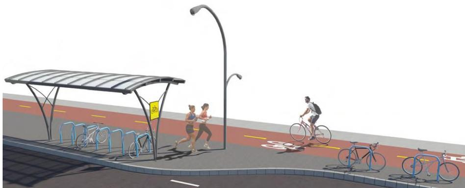
Figura 211 - Instalação de paraciclos em paralelo (esq.) e em linha (dir.). Fonte: Caderno Técnico para Projetos de Mobilidade Urbana (BRASIL, 2017)
