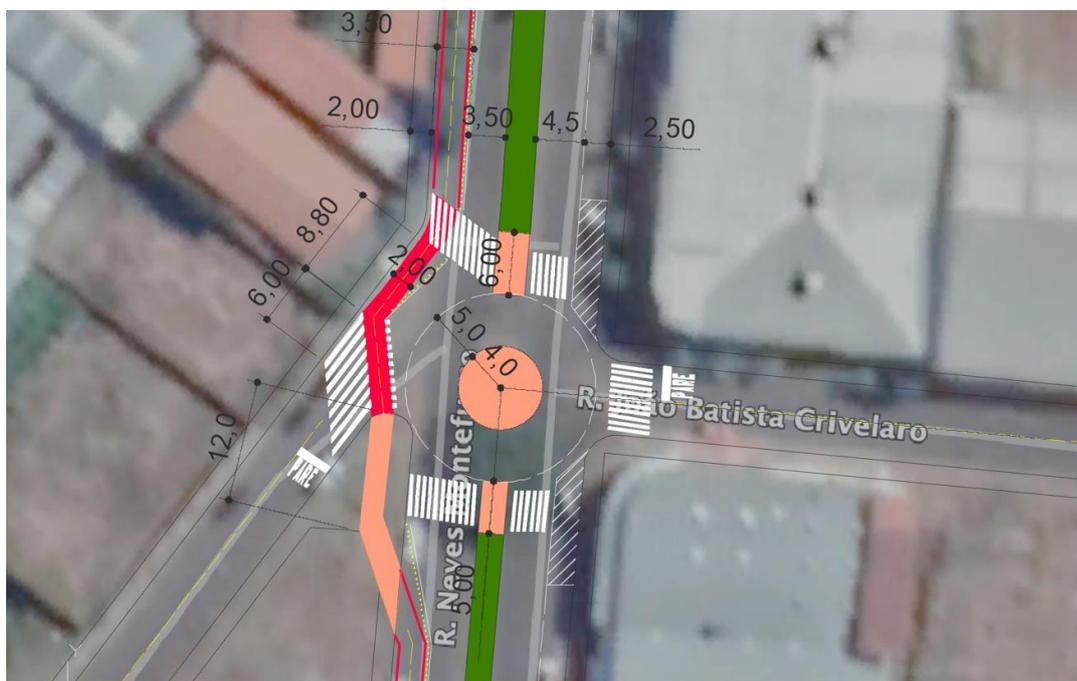
Figura 143 – Projeto de Interseção – Rua Neves Montefusco x Rua Batista Crivelari, com implantação de infraestrutura cicloviária proposta em plano de ação. Fonte: Polo Planejamento
