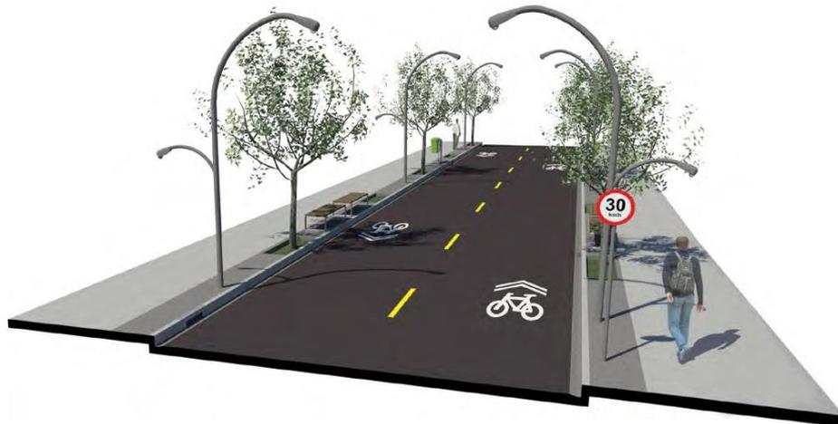
Figura 222 - Sinalização do tipo *sharrow*, indicada para ciclorrotas. Fonte: Caderno técnico para projetos de mobilidade urbana (BRASIL, 2017).
