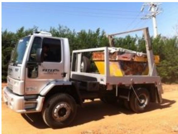
Figura 61. Caminhão poliguindaste simples
