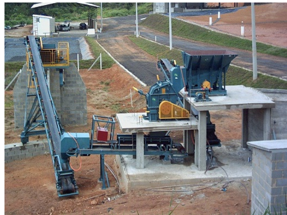
Figura 265. Modelos de sistemas de britagem e peneiramento fixos.
