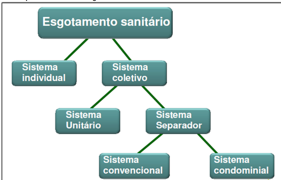
Figura 211. Tipos de sistema de esgotamento sanitário
