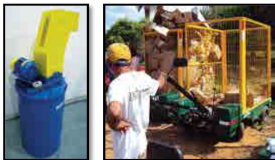
Figura 252. Picotador de vidro e carrinho elétrico respectivamente
