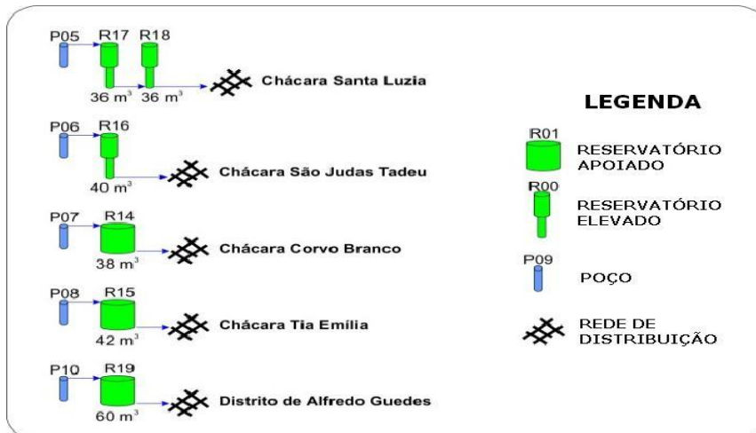
FIGURA 5- 10: REPRESENTAÇÃO ESQUEMÁTICA DOS SAA ISOLADOS
