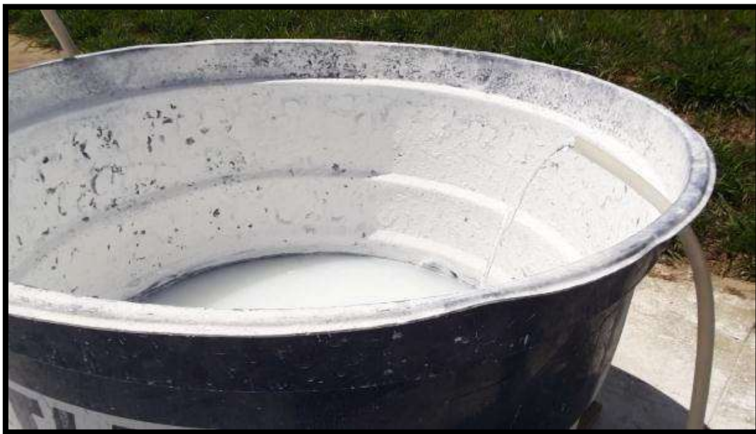
Figura 24 - Dosagem de Cal Hidratado para correção do pH
