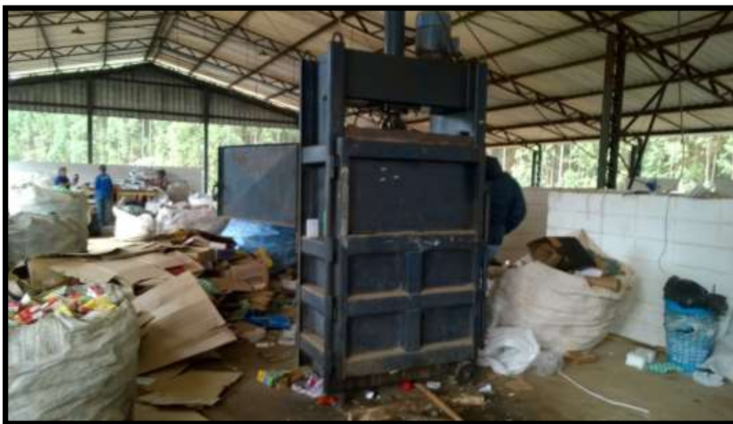
Figura 47 - Prensa no Centro de Triagem de Itirapina
