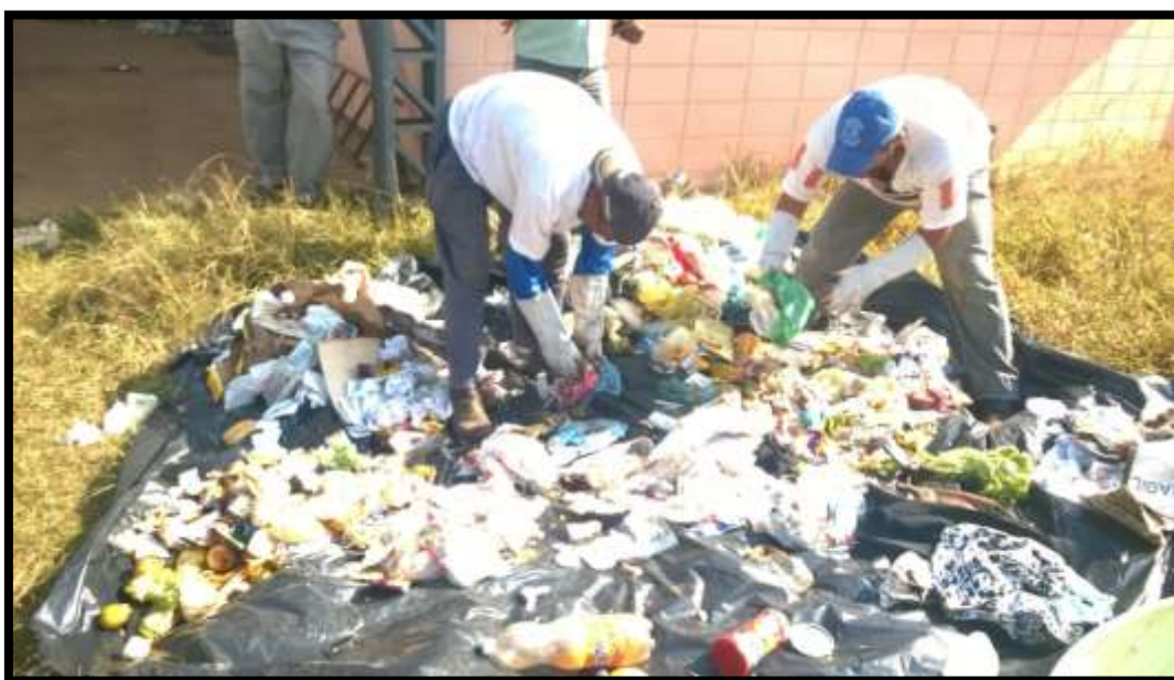
Figura 36 - Realização do Ensaio de Composição Gravimétrica em Itirapina
