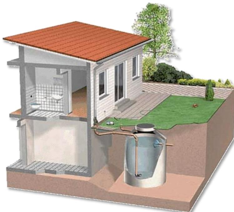
Figura 12-1: Ilustração de sistema de armazenamento de água da chuva para usos residencial não potável
