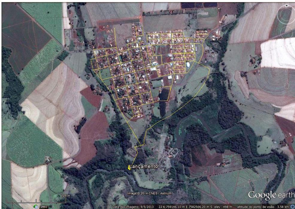
**Figura 10-1: Imagem área com indicação da rede de esgoto, emissários e local de lançamento no Rio Jacaré-Guaçu**
