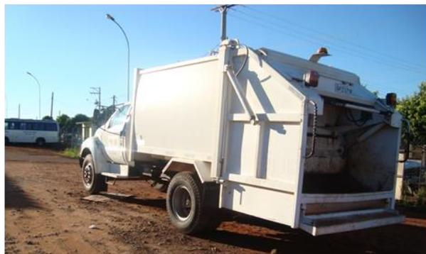
Foto 11-1: Caminhão compactador utilizado na coleta de RSD
