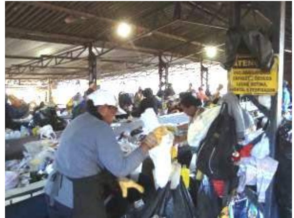
Foto 8.1.2.3-2 Separação dos recicláveis por catadores nas esteiras
