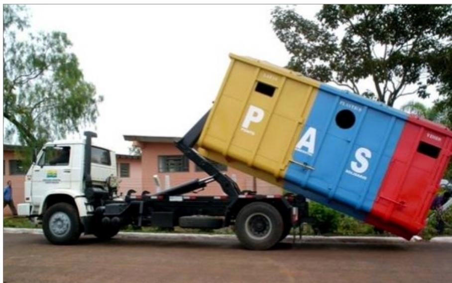
Figura 12: Sistema de Coleta Seletiva – Contêiner PAS e caminhão roll-on roll-off
