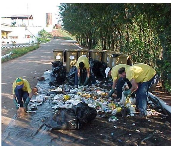
Figura 4: Procedimentos para a análise gravimétrica
