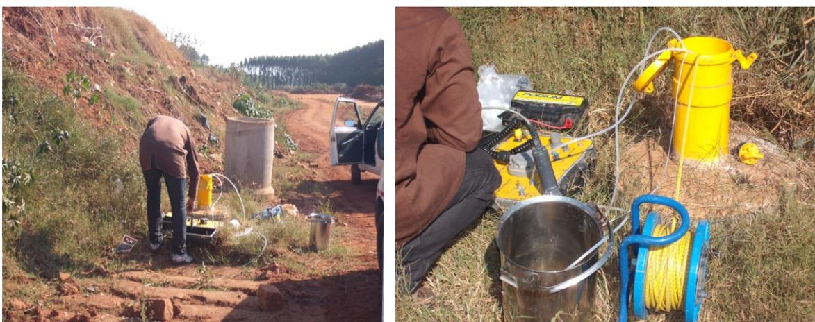
Figura 31: Processo de coleta e análise das águas subterrâneas do aterro municipal
