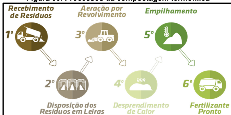
Figura 50. Processos da compostagem termofílica
