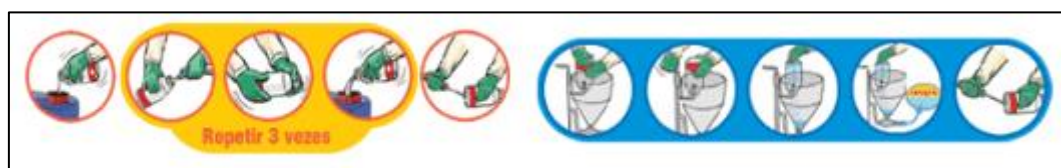
Figura 50: Tríplice lavagem e lavagem pressão das embalagens de agrotóxico - Fonte: INPEV, 2006.
