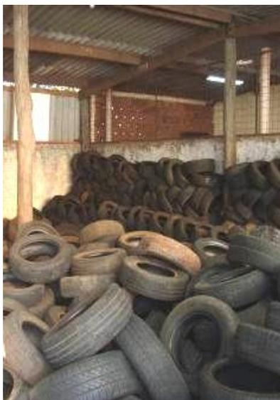
Figura 52. Baias cobertas para armazenamento de pneus inservíveis
