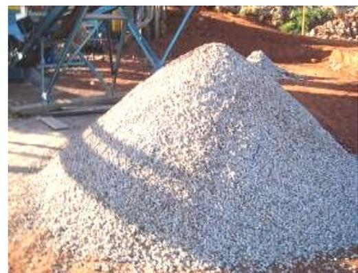
Figura 29. Agregado reciclado produzido na Usina de RCC da Morada Ambiental
