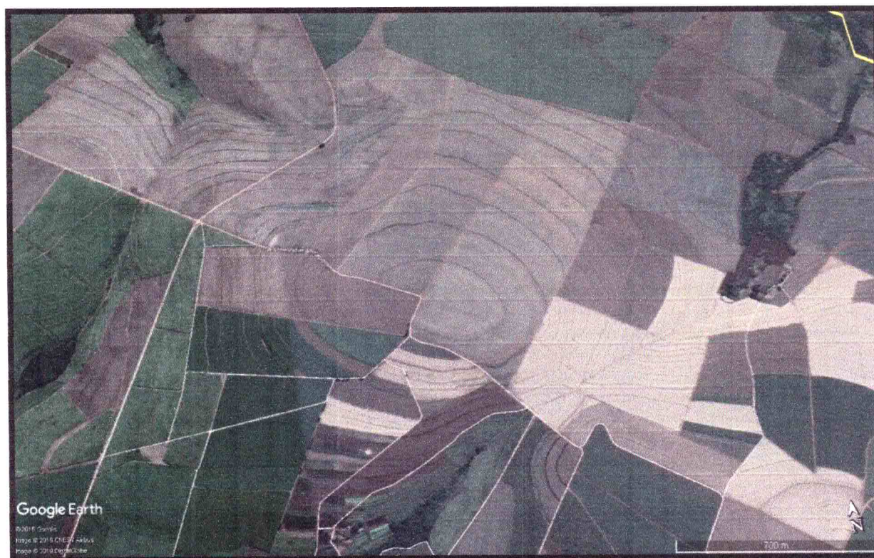
Figura 24: Terraceamento e sistematização de plantio adequados ao controle de processos erosivos
