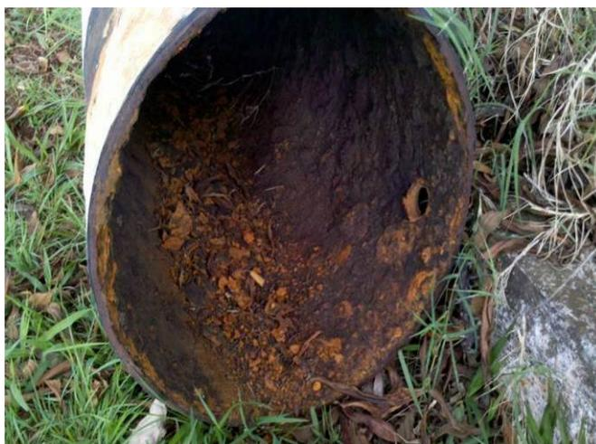
Figura 134. Vista de tubulação de FoFo com formação de incrustações
