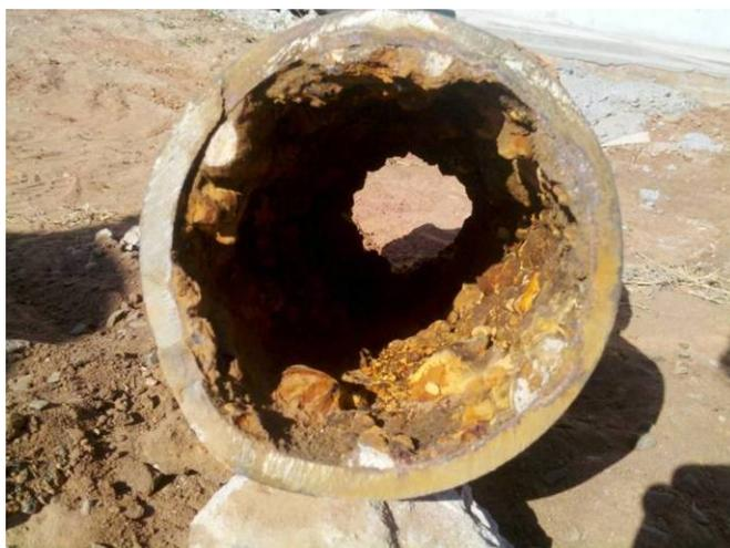
Figura 133. Vista de tubulação de FoFo com incrustação
