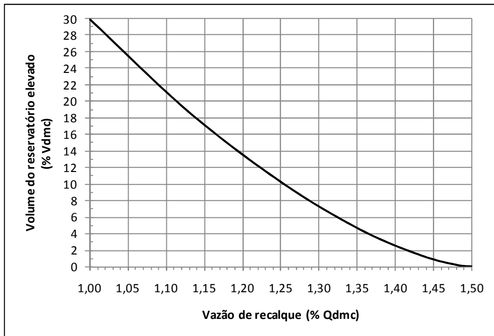
Figura 2.3 - Relação entre a capacidade do reservatório elevado e a vazão de recalque entre os reservatórios semi-enterrado (ou apoiado) e o elevado para um volume de armazenamento total de 30 % do V_{dmc}
