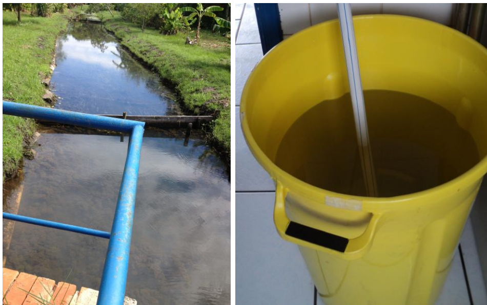
Figura 3.4– Local de coleta do sedimento e água de estudo II preparada com turbidez ~25 uT
