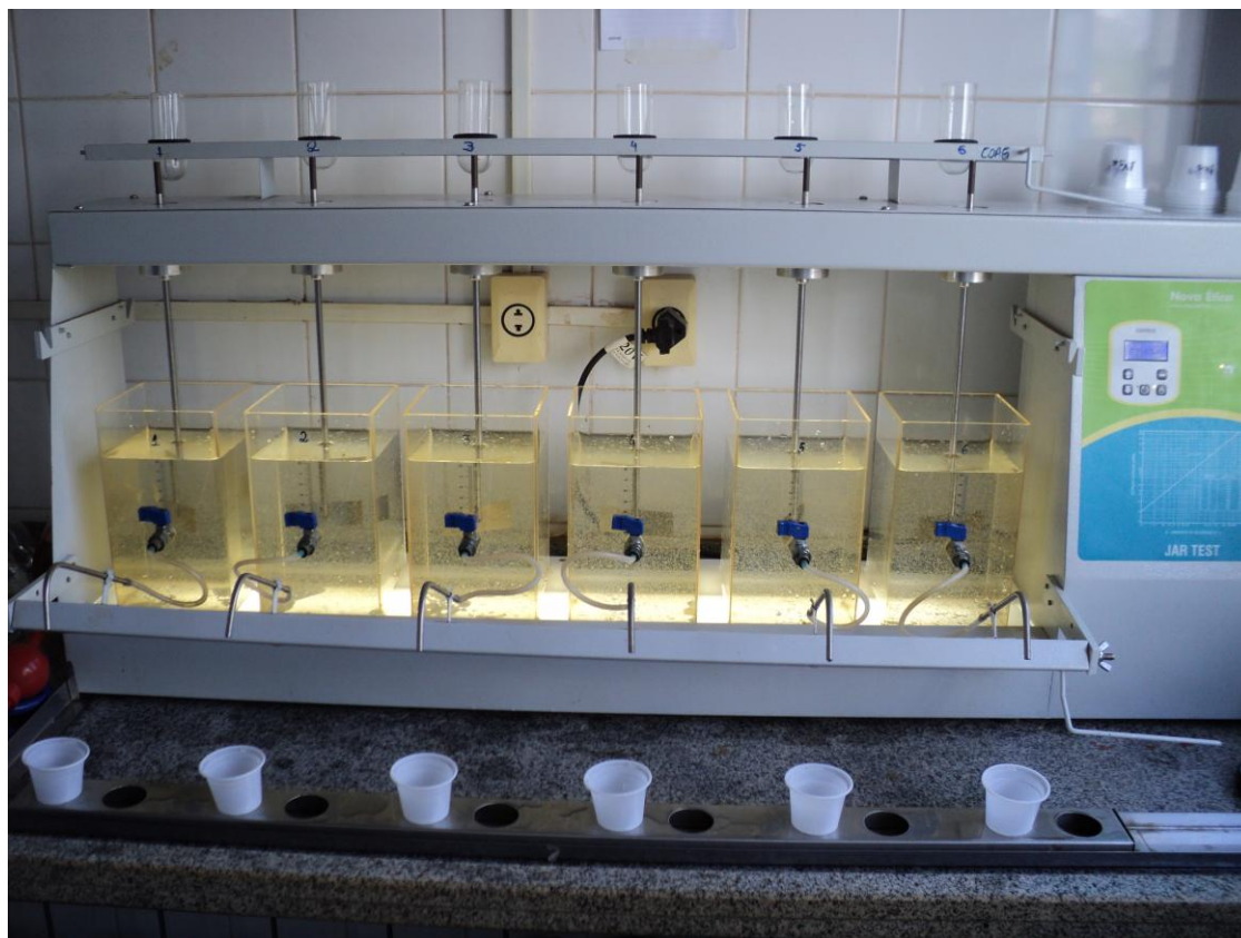
Figura 3.9 - Foto do ensaio com a água de estudo II e uso do PAC como coagulante
