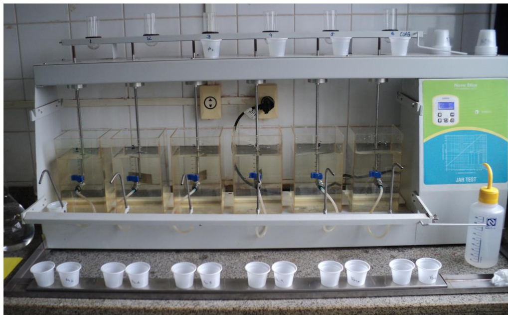
Figura 3.5 - Foto do ensaio com a água de estudo I e uso do PAC como coagulante
