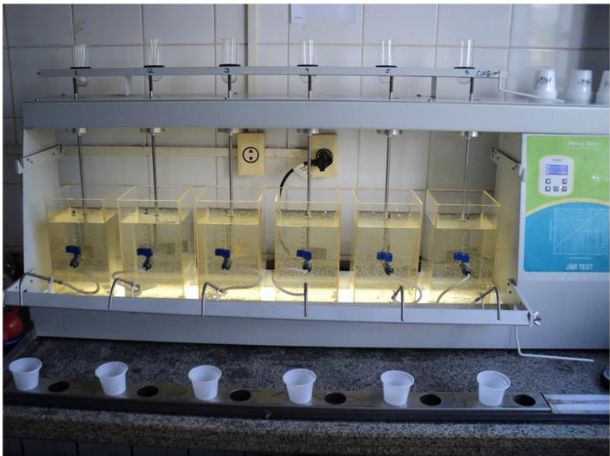
Figura 7.5 - Foto do ensaio com a água de estudo II e uso do PAC como coagulante
