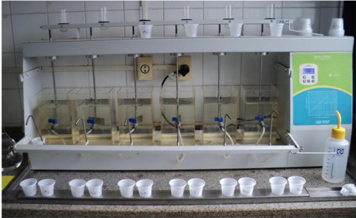
Figura 7.1 - Foto do ensaio com a água de estudo I e uso do PAC como coagulante
