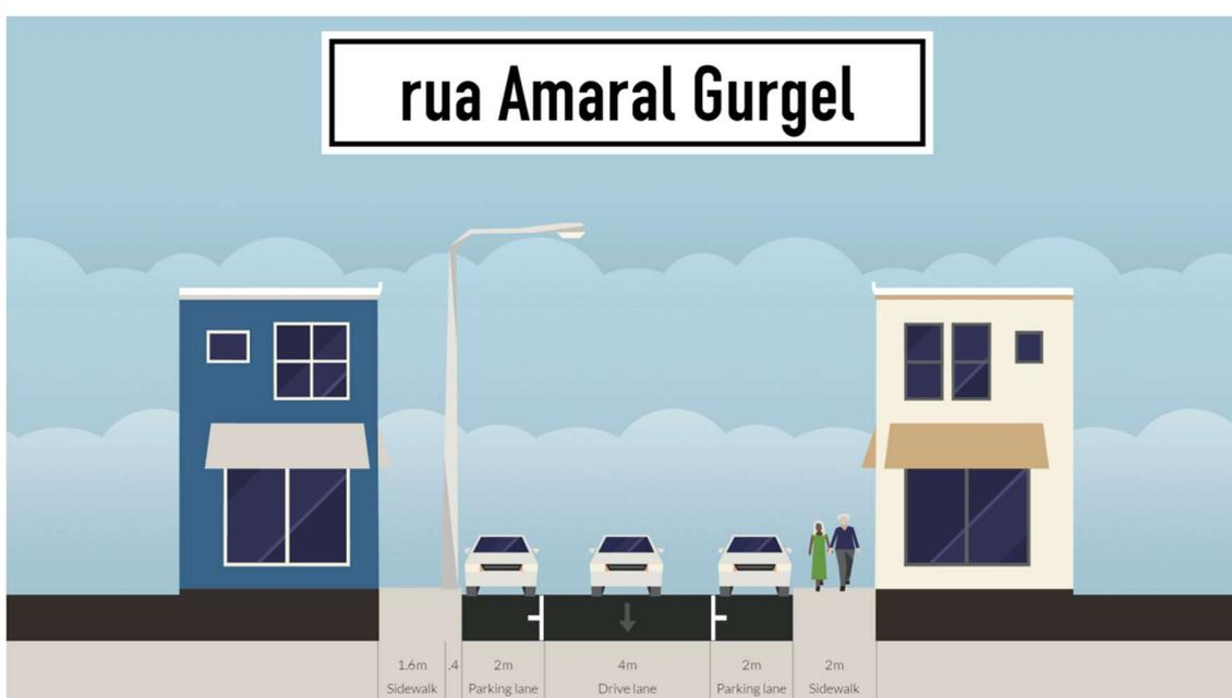
**Figura 62:** corte esquemático da Rua Amaral Gurgel. Fonte: Street Mix. Elaboração: própria.
