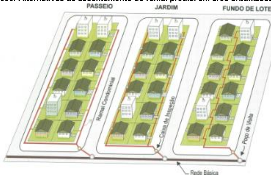
Figura 335: Alternativas de assentamento do ramal predial em área urbanizada regular.
