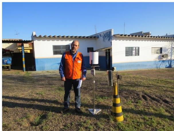
**FOTO 156** – Registro do pluviômetro semi-automático instalado no terreno da Defesa Civil de São Carlos. O equipamento, cedido pelo Centro Nacional de Monitoramento e Alerta a Desastres – CEMADEN, está sendo utilizado para monitoramento das chuvas em determinado setor do município.
