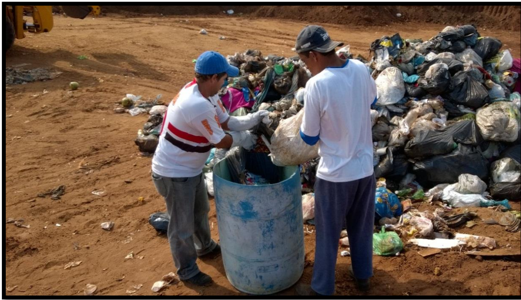
Figura 33 - Realização do Ensaio de Composição Gravimétrica em Itirapina
