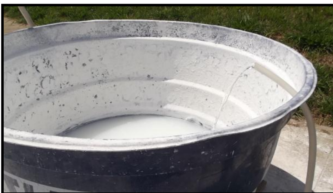
Figura 25 - Dosagem de Cal Hidratado para correção do pH
