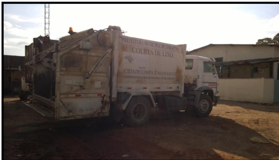
Figura 39 - Caminhão Compactador Utilizado na Coleta de Resíduos Sólidos Urbanos
