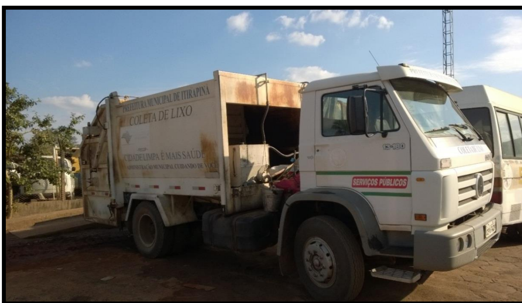
Figura 38 - Caminhão Compactador Utilizado na Coleta de Resíduos Sólidos Urbanos
